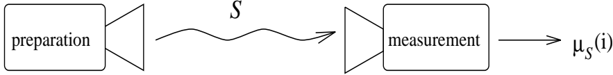
Рис. 2.1. Квантовое состояние, описываемое оператором плотности S , характеризует приготовление системы, тогда как статистика измерений описывается вероятностной мерой \mu_S^M(x) , где x обозначает возможные исходы измерения.
